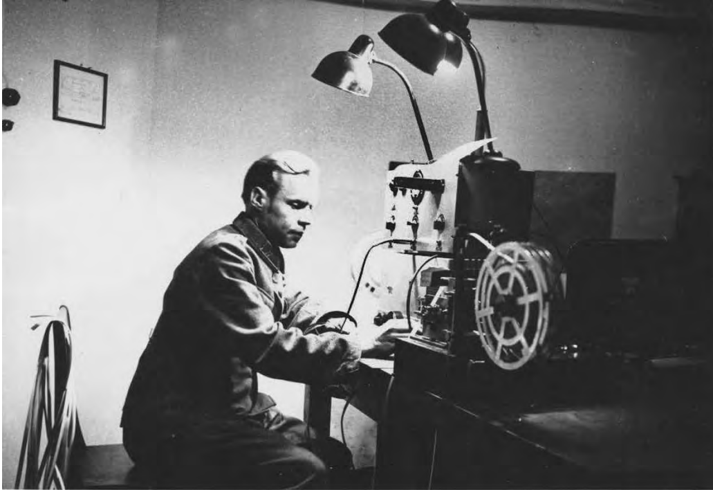
Diplomaattiviestit sähkötettiin erittäin suurella nopeudella. Niiden vastaanottamiseen käytettiin tällaista piirturia, undulaattoria. Morsemerkit tulkittiin sitten käsityönä tulostusnauhalta.
